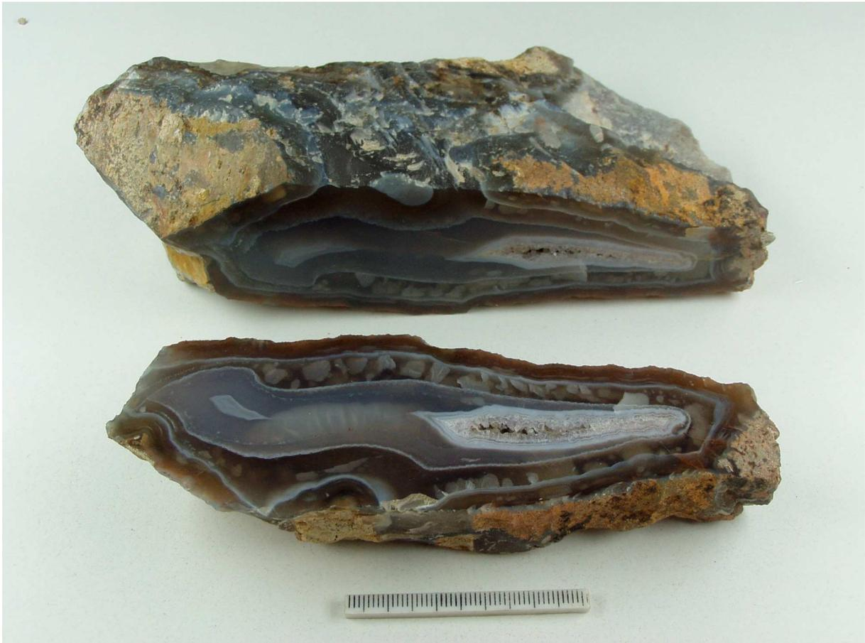
*Abb. 8: Chalcedon (I) mit inneren Spannungsrissen.*
